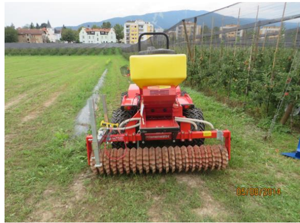
Slika 23: Sejalnica z rebrastimi koluti (Foto: M. Mavsar)
