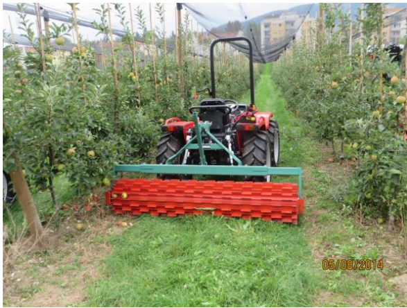
Slika 22: Rebrasti valj za mečkanje trave (Foto: M. Mavsar)
