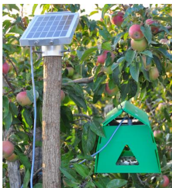
Slika 1: Moderna feromonska vaba, opremljena s kamero za štetje žuželk Trapview (Vir fotografije: http://www.efos.si/sl/ ; EFOS, Matej Štefančič)
