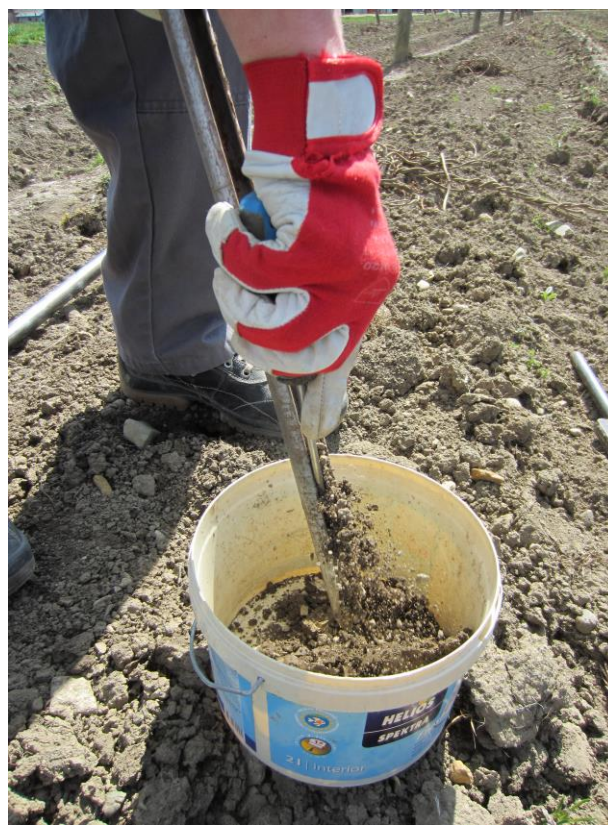
Slika 10: Vso zemljo iz sonde postrgamo v čisto vedro. (Foto: B. Čeh)
